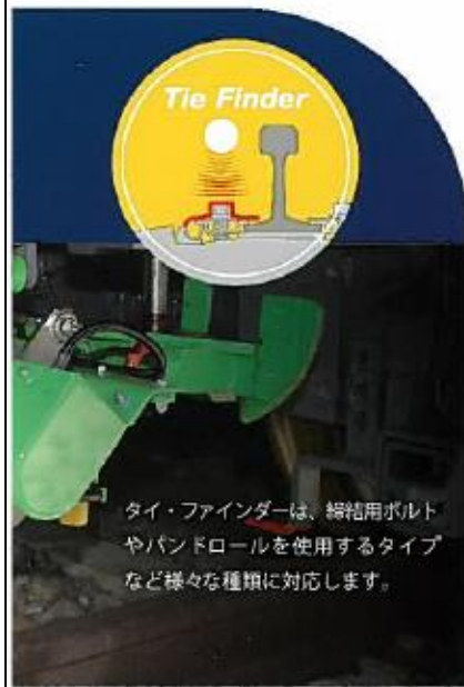
圖 99 09 系列砸道車砸道機構之最新擠緊功能技術
