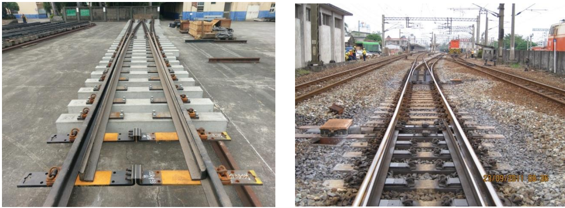
圖 49 臺鐵局現有尖軌滑床板無滾輪
