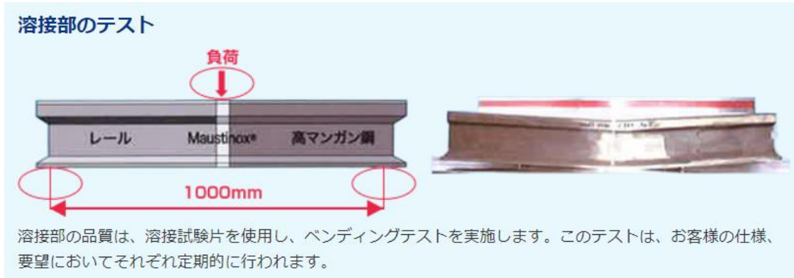
圖 38 焊接段彎曲試驗
