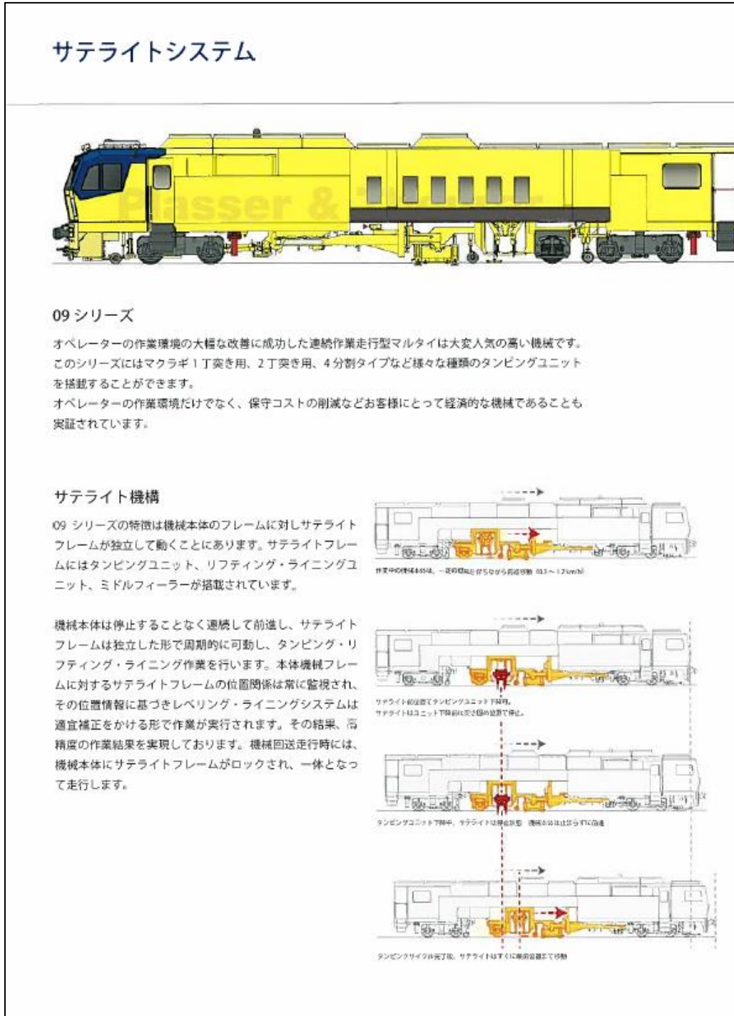
圖 97 09 系列砸道車滑移砸道示意圖
