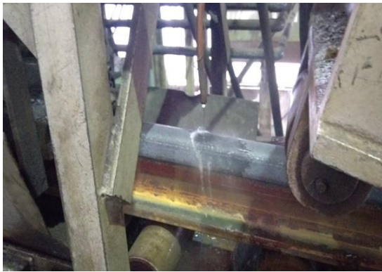
圖 30 尖軌熱處理後之冷卻工序(1)
