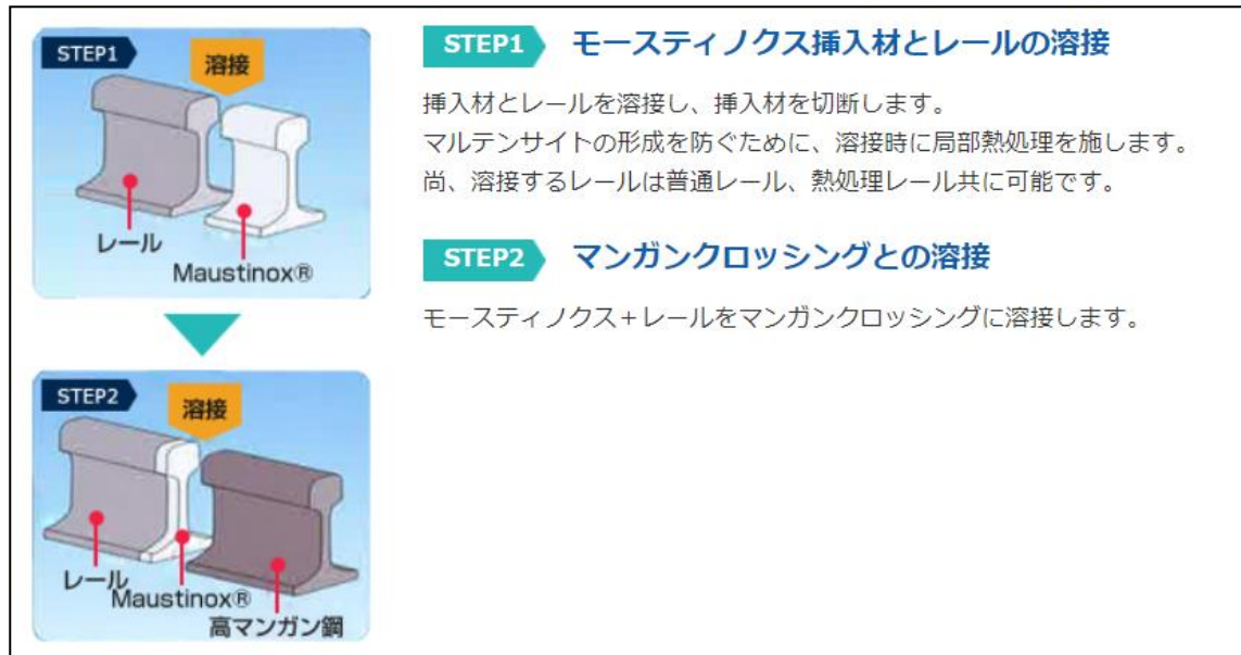
圖 37 高錳鋼岔心焊接步驟圖
