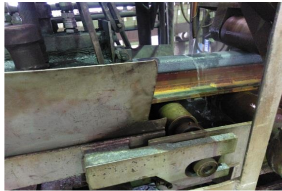
圖 31 尖軌熱處理後之冷卻工序(2)
