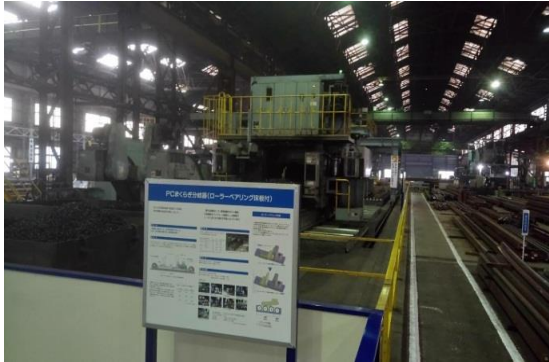
圖 14 可連續 64 小時尖軌自動加工機
