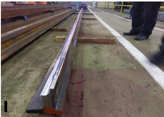
圖 24 尖軌趾端部加工半成品
