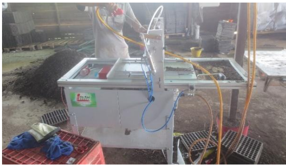
圖 61.義大利 Da Ros 簡易型蔬菜種子真空播種機，型號 SEM100
