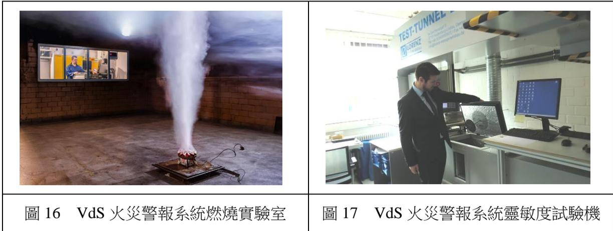
圖 16 VdS 火災警報系統燃燒實驗室
