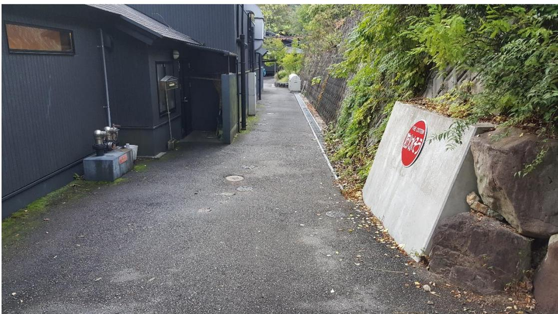
圖 41：旅館外防火水槽及採水口
