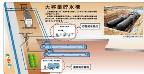
緊急貯留システム(大容量貯水槽)
