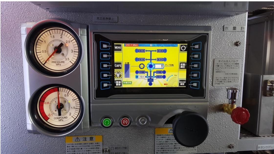
圖 23：觸控式流量控制盤
