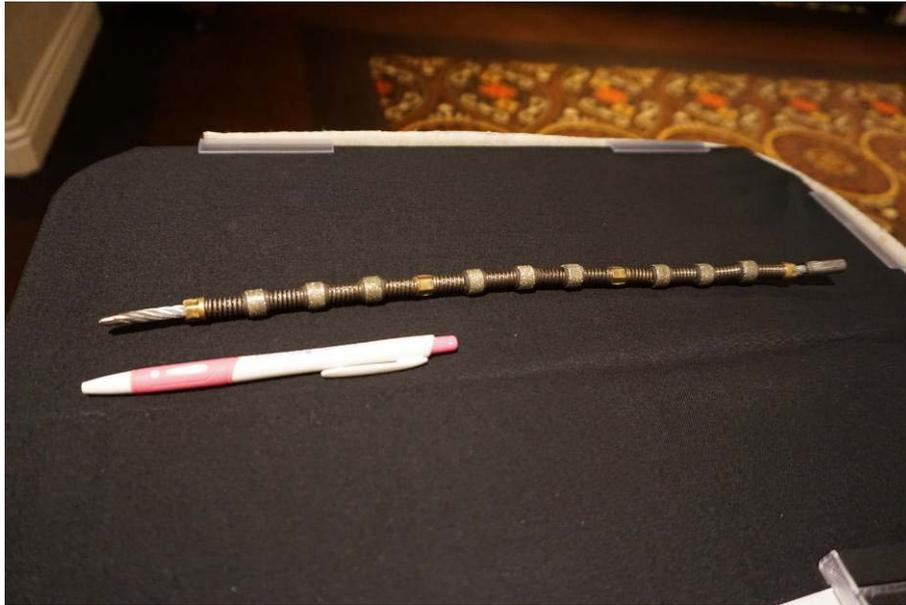
圖 11 課程中展示的鑽石索鋸(Diamond Wire Cutting)繩索
