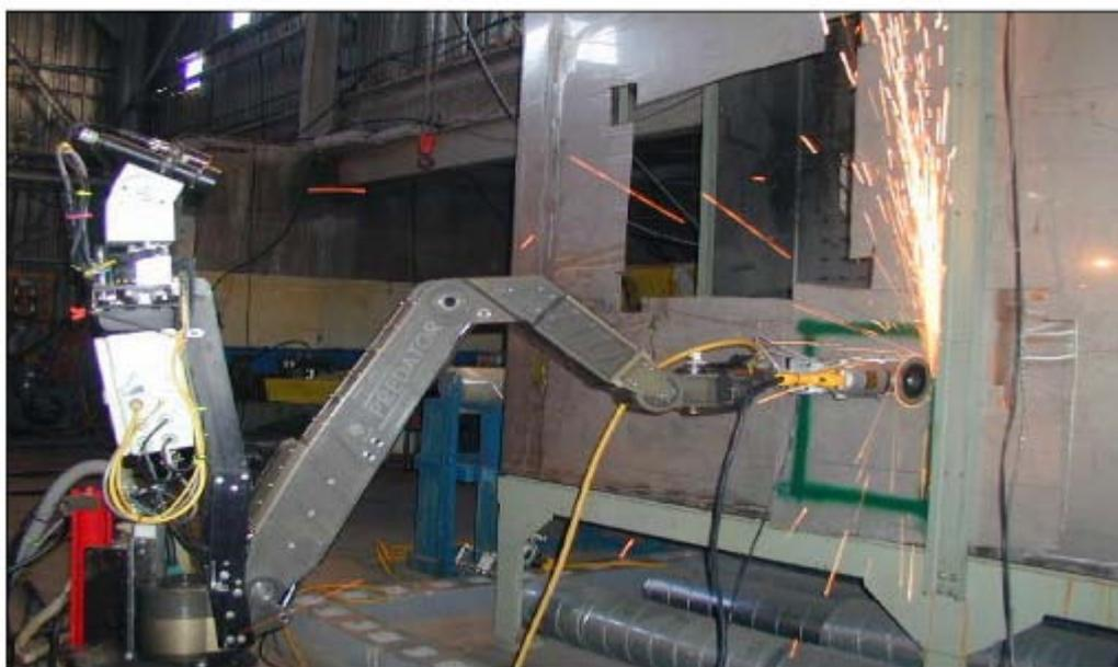
圖 10 將以機械手臂進行切割前的模擬測試。
