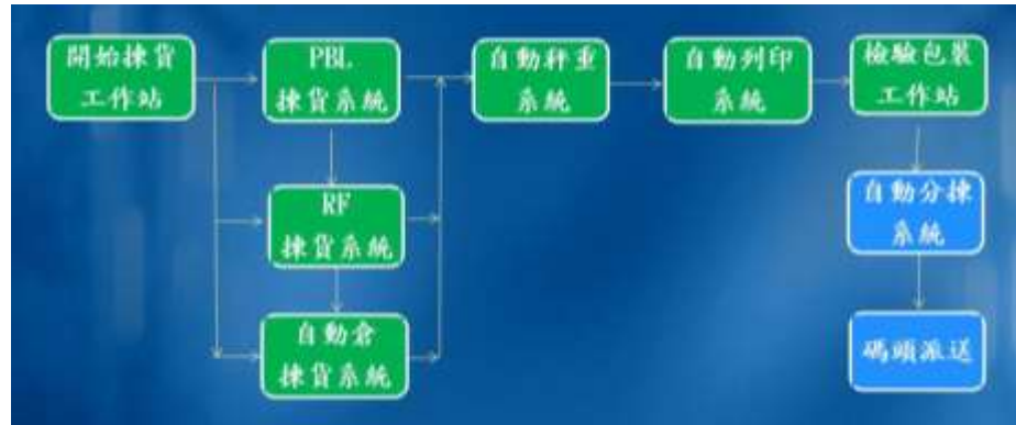
圖 31、新加坡郵政-自動化揀貨流程
