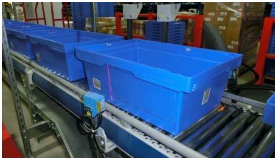
圖 32、新加坡郵政-周圍貼有條碼的揀貨箱通過輸送帶上條碼掃描器讀取揀貨箱上之條碼，將訂單自動連結揀貨箱
