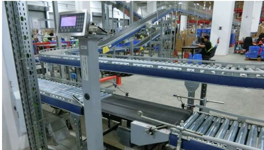
圖 35、新加坡郵政-自動稱重系統
