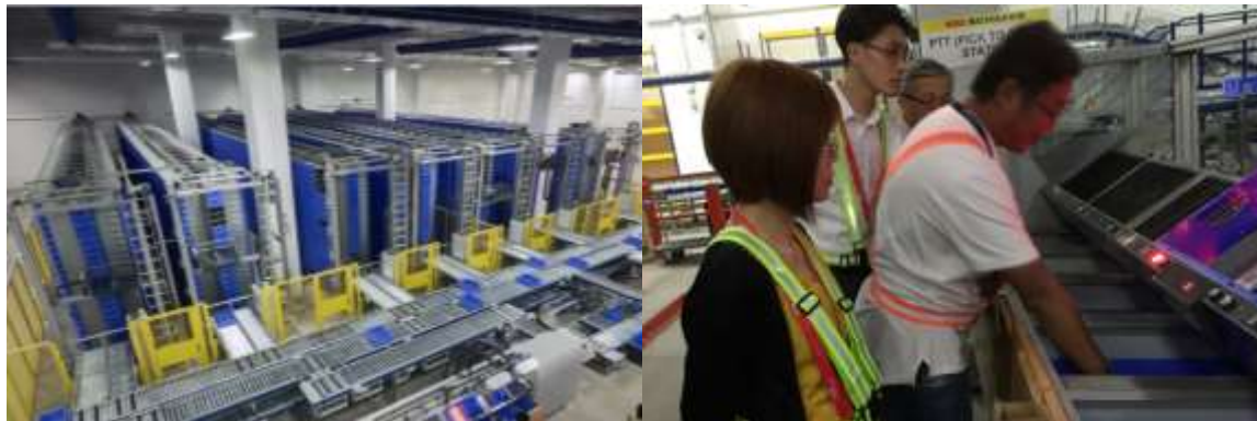
圖 34、新加坡郵政-(左)水平旋轉式(Carousel)存取系統揀貨區、(右)新郵倉儲人員解說自動存取系統揀貨作業情形
