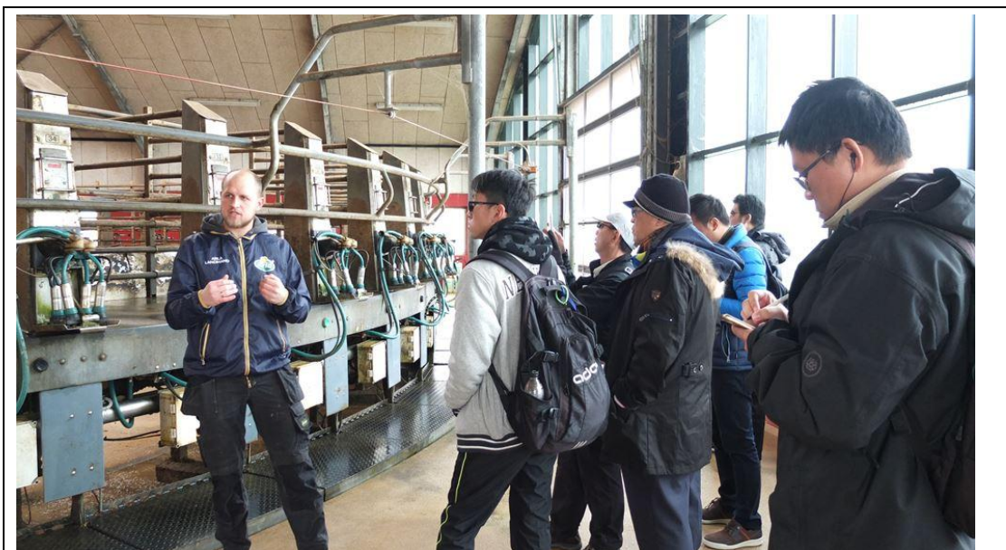
圖 3、Peter 向代表團展示輪盤式擠奶設備，擠乳時可透過牛隻身上的 RFID tag 讀取該牛隻的乳品質與產量
