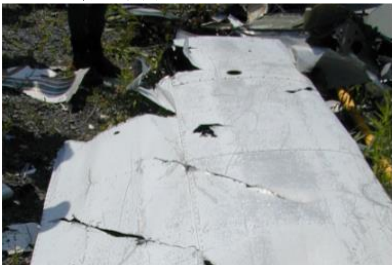
上圖為空中碰撞飛機殘骸，以其執行碰撞角度研判範例
