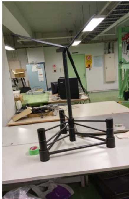
圖 3 浮動式離岸風機載台縮尺模型
