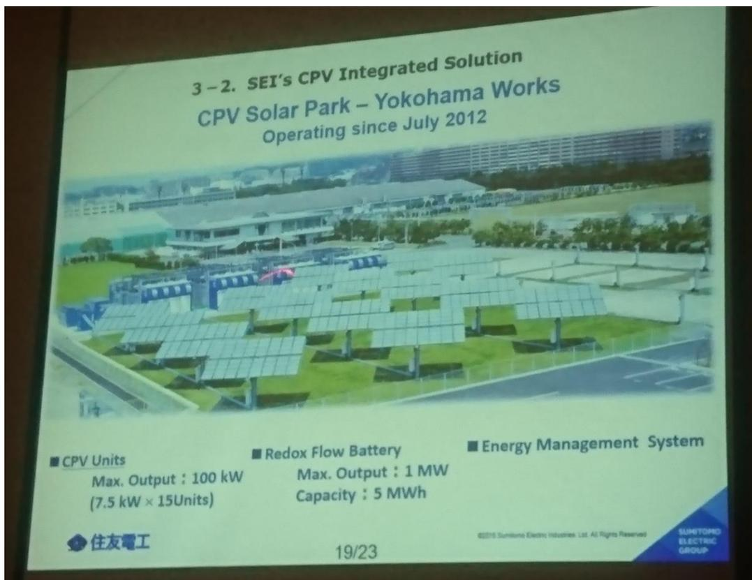
圖 24、Sumi tomo 在橫濱架設的聚光型發電及儲能系統
