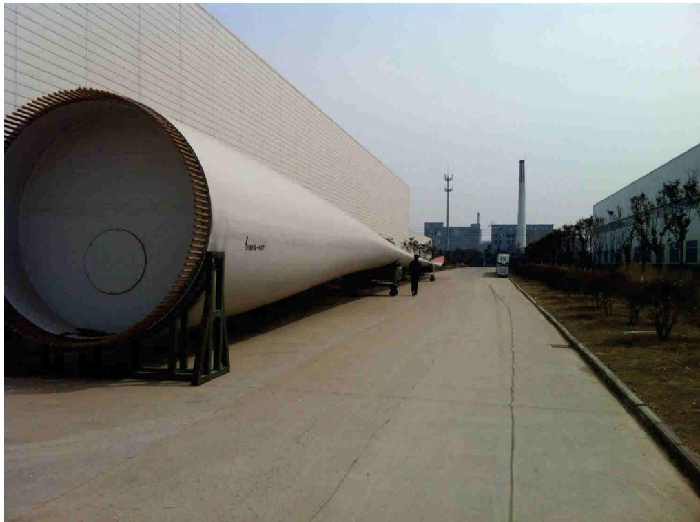
现有的风电叶片主要由玻璃纤维复合材料制成，也有一些为碳纤维复合材料，并附以泡沫，木板等结构，我们主要关心的是玻纤和碳纤复合材料部分，而不考虑泡沫和木板结构区域
