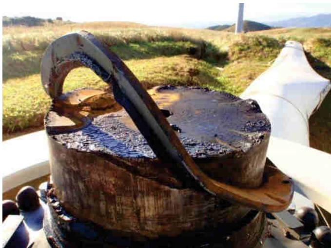
转轴断裂实物照片
