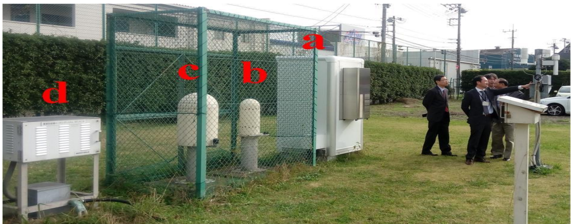
圖 13 環境輻射監測設施 (a 純鍺偵檢器加馬能普分析系統 b 3 英吋 NaI 閃爍偵檢器 c 中壓游離腔 d 低容量連續抽氣裝置)
