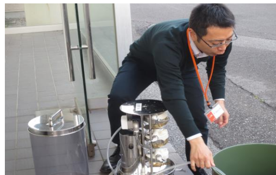
圖 10 野外水中銫濃縮的裝備操作示範
