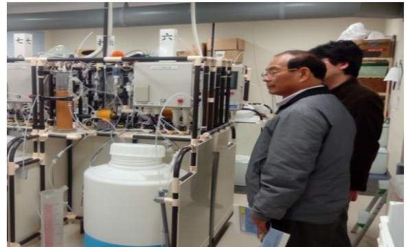
圖 19 海水自動濃縮設備
