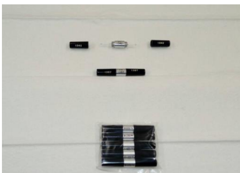
圖 5 熱發光劑量計(TLD)
