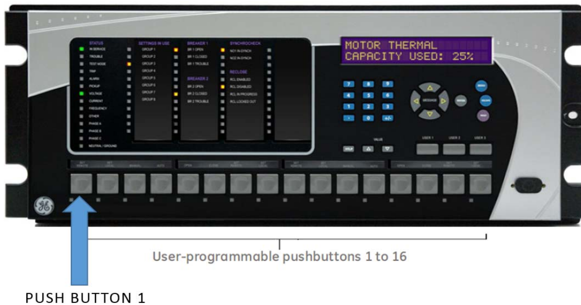
圖 26. 設定 GE L90 電驛 PUSH BUTTON 1 狀態訊息
