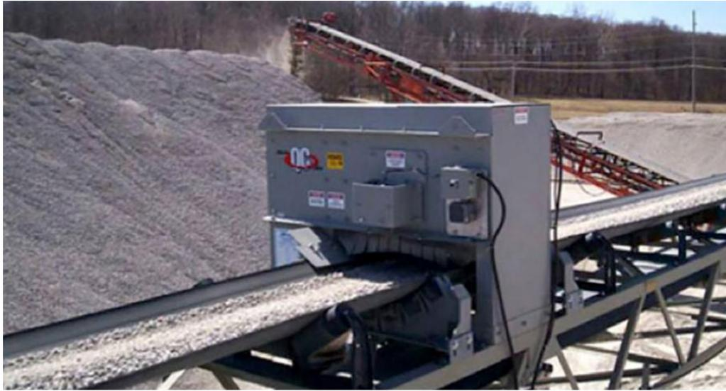
另一種“皮帶”切割機系統，其通過移動的犁(沿輸送機的長度)將材料從輸送帶上拋出，然後通過固定的切割機將該拋出的材料的一部分取出。隨著材料沿輸送帶移動，來自輸送機長度的樣品被推向一側的一組料倉，如圖 3 皮帶採樣系統所示
