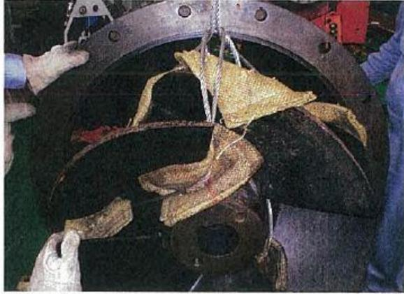
將葉片安裝於泵軸上，確保鍵的位置已定位，再移除鋼索
