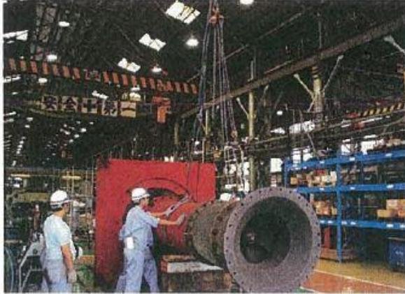
移除水柱管和出口座間螺栓
