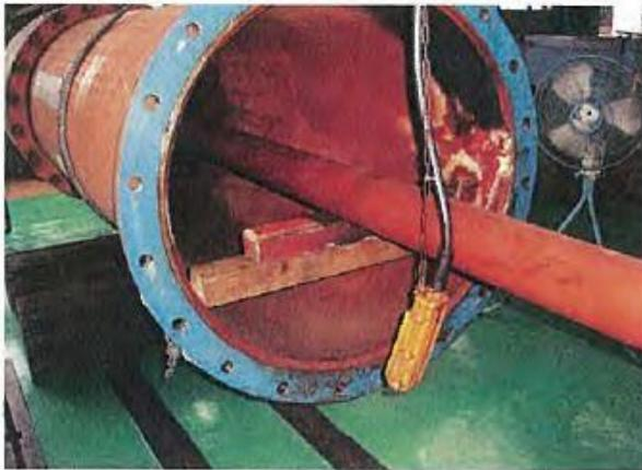
水柱管和出口座已分離
