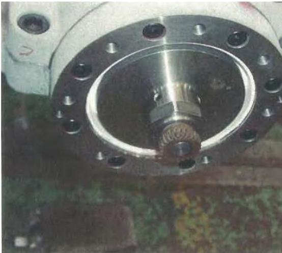
53.安裝轉軸行程量測板
