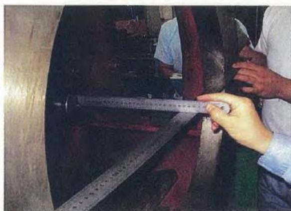
量測馬達基座和軸端之距離
