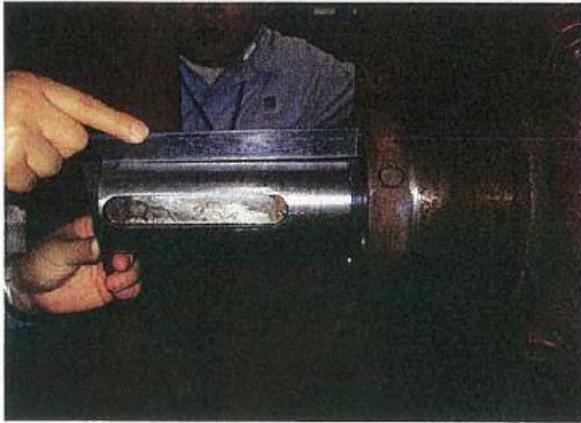
量測調整螺帽和泵軸底端之距離，比較拆解前之量測值
