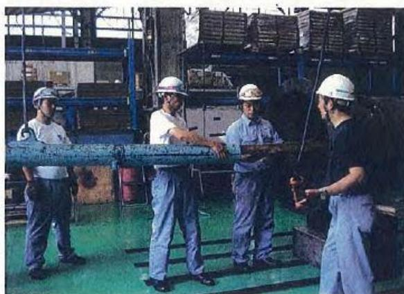
敲擊葉片螺帽到葉片接觸導架，再進行量測一次，兩次量測值相減即為軸的移動行程
