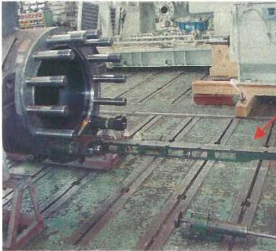
16. 安裝拖拉治具(Pushing jig)於外缸
