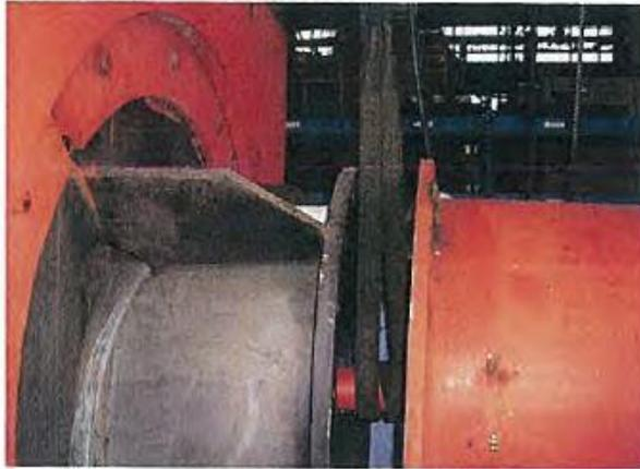
移除水栓管時，須用吊車懸吊泵軸，避免因軸承移除時，造成撓曲
