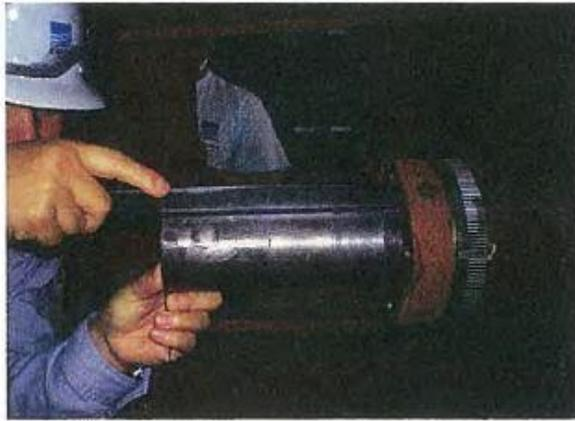
移除鍵(key)前，先量測調整螺帽和軸底端之距離
