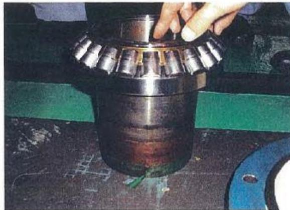
軸頸和止推軸承已分離
