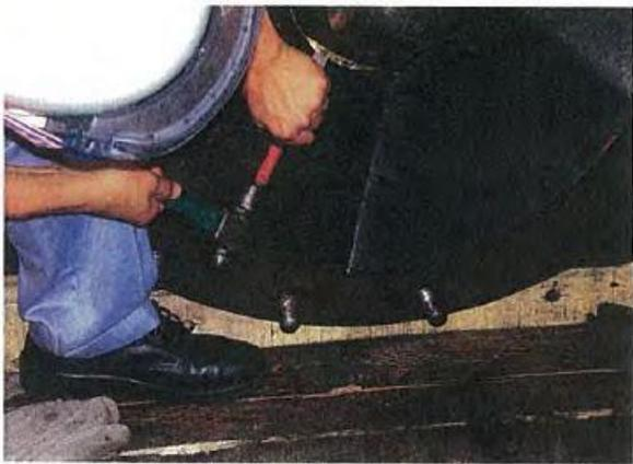
將墊圈彎曲一角，以鎖住固
