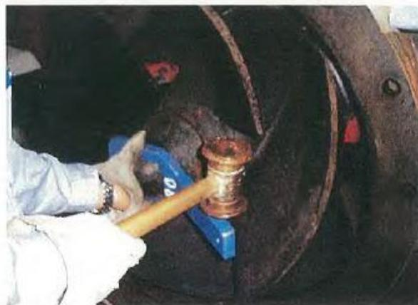
先固定泵軸，再以夾具和錘子或管板手來鬆開葉片螺帽
