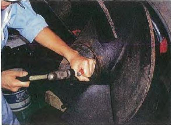
因墊圈已被彎曲用來固定葉片螺帽，所以先用鑿子和錘子敲平墊圈
