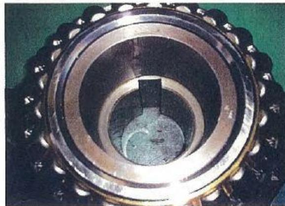
軸頸和止推軸承已分離
