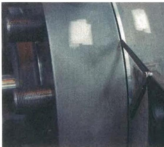
25.檢查外缸蓋與外缸壁之間隙
