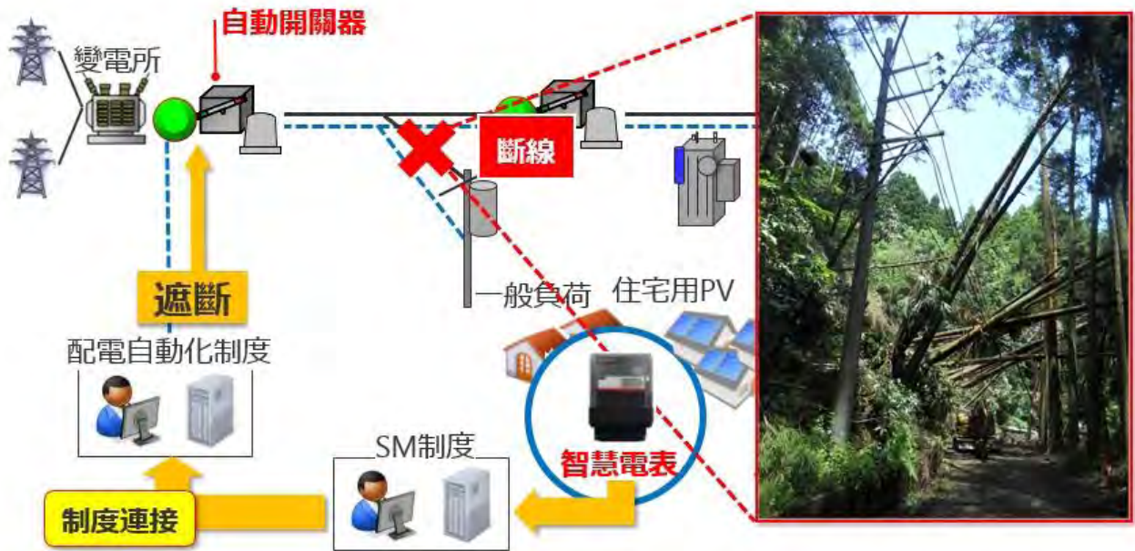
圖3-52 AMI檢測斷線示意圖
