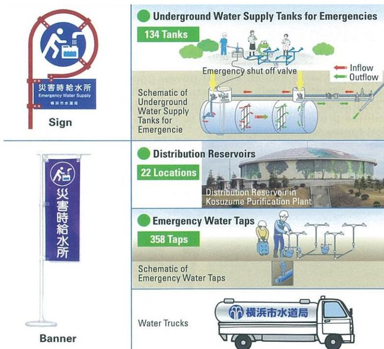
圖 貳-26 災害發生時之緊急供水系統
