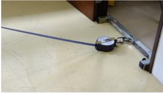
圖 7 移動式臨時防墜系統裝置安全訓練
