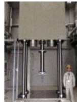
圧壊試験装置
