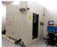
X線CTスキャン装置 (設置場所: 管理実験棟) Sample: 60x60x60cm
