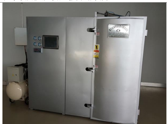
中國雕版印刷博物館雕版庫房氮氣除蟲設備
