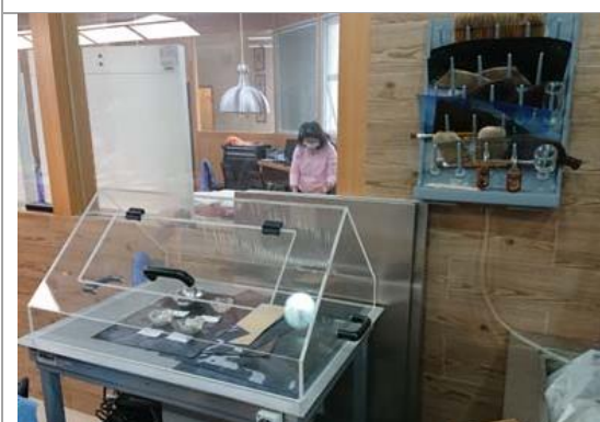
南京大學圖書館古籍特藏部修復中心之抽氣罩等相關設備
