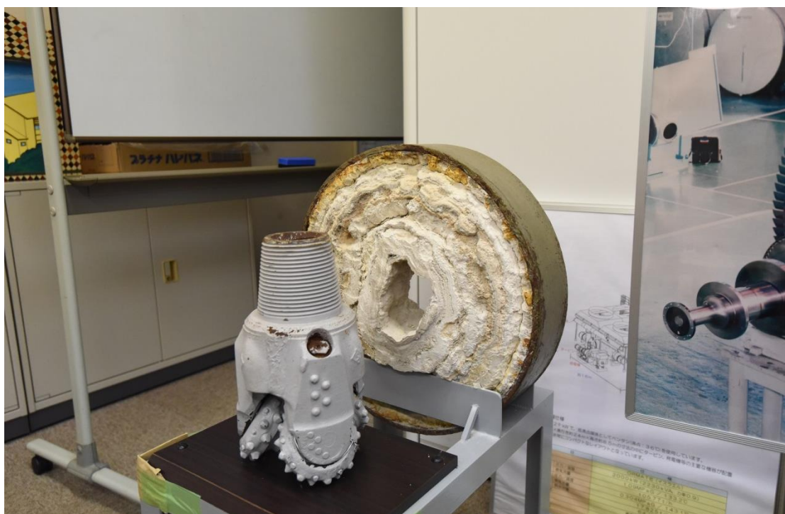
圖 20 現場展示鑽井用的鑽頭以及結垢的井管
