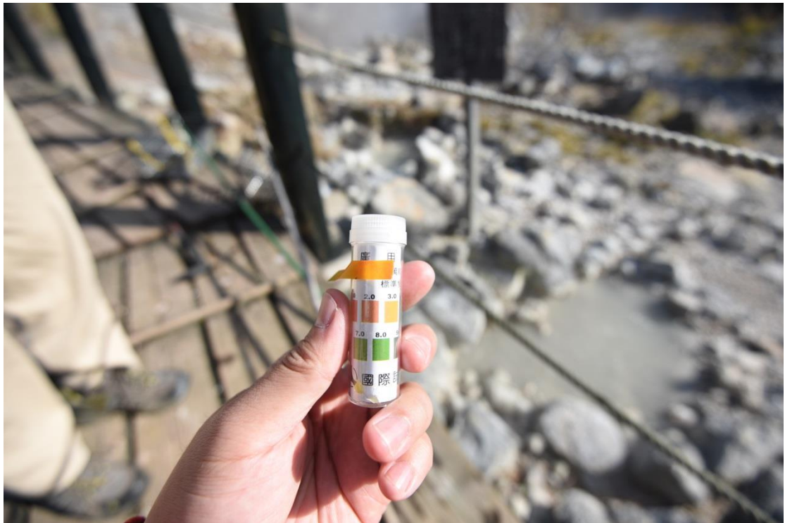
圖 23 小松地獄的溫泉水經廣用試紙檢測，pH 值介於 2~3 之間
