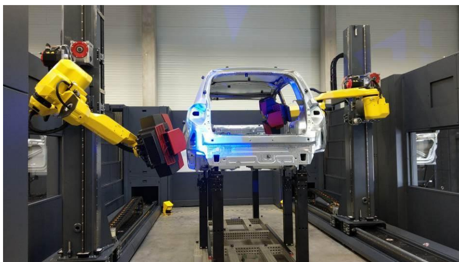
圖 2.3-2 現場展示之 ATOS ScanBox8 系列掃描系統
