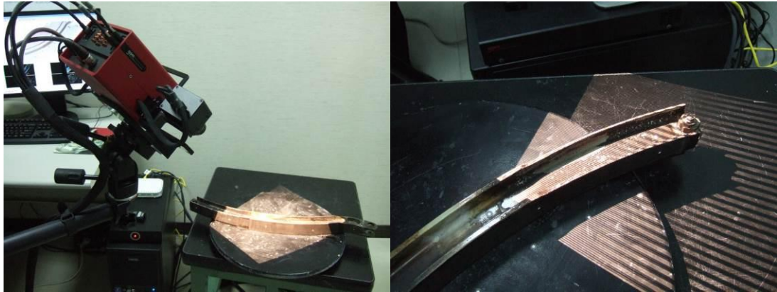
圖 2.2-1 ATOS I 光學掃描系統及光柵變化情形
