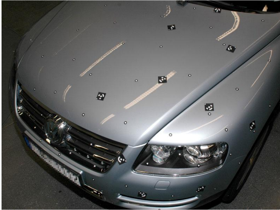
圖 2.7-1 於待測物貼上定位控制點
