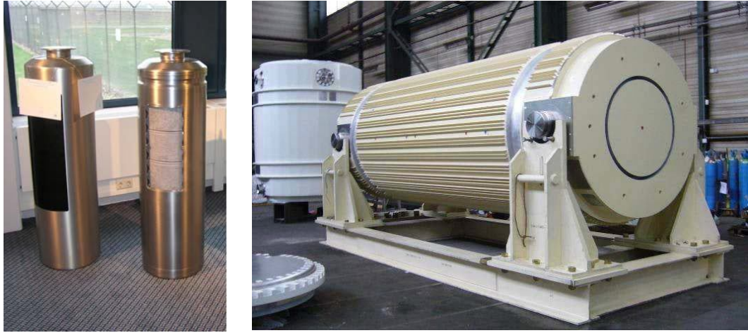
圖 9 ANSTO 用過燃料再處理後產生的 IWL，先以玻璃固化處理，再放入 500 公斤中的不銹鋼罐內(圖左)，最後再裝入 100 噸重的 AREVA TN-81 護箱內(圖右，護箱具備貯存和運輸功能)，每只護箱能夠存貯存 28 罐不銹鋼罐。
