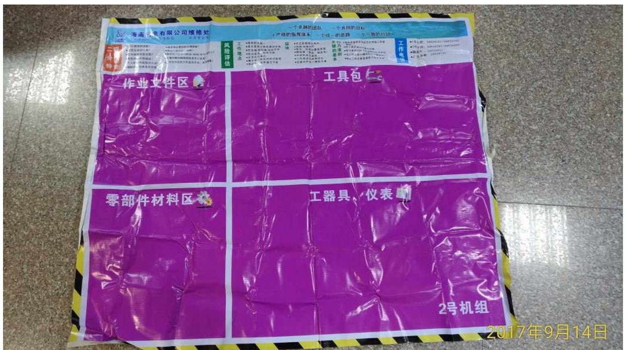
圖五、海南昌江核電廠現場作業的工作布，明顯標示現場作業物品的擺放位置。
