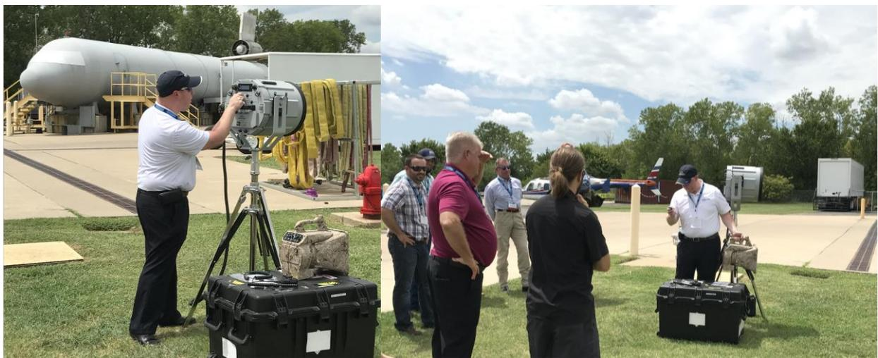
(三) DeTect雷達公司：該公司製造之MERLIN「飛機鳥擊迴避雷達系統」為可連續監測使用者所定義之鳥類和野生動物，可於偵測目標後自動化啟動鳥類威懾裝置以防止鳥類入侵，目前廣泛運用於美國軍、民用機場，提供鳥類撞擊飛機風險管理和危險鳥類活動之即時偵測、追蹤與警報。該裝備可設置於固定地點外、亦可採車載式裝設，提高機動性，並且是唯一經美國國家飛行安全標準認證可在架設於機場塔台周邊使用之鳥類雷達，依功率、功能性不同，售價約在美金35至50萬元，雖其功能性極佳，惟其裝設、後續維持及整合相關自動化驅鳥裝置等所需經費高昂，是否適合我軍採購、建置仍須審慎評估。
