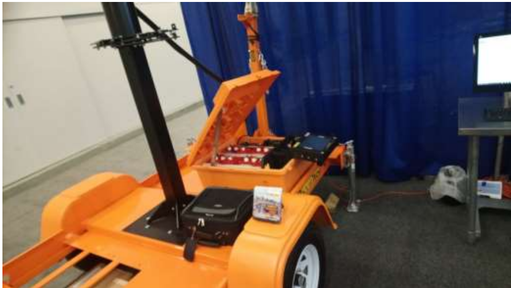
圖 17. 太陽能資訊可變標誌電池組
