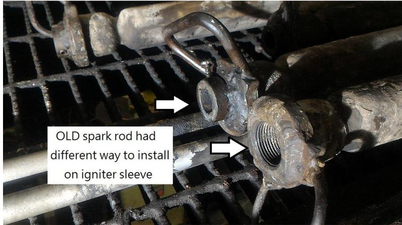
FIGURE 15. IGNITER SLEEVE FOR SPARK ROD (BEFORE)
