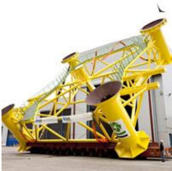
圖表 48 打樁模板(Piling template)
