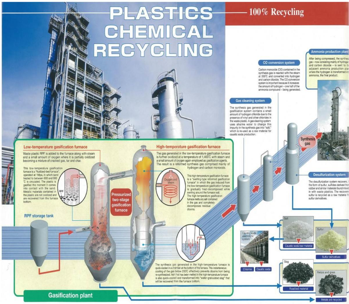
圖 6-2 昭和電工廢塑料回收氣之流程
