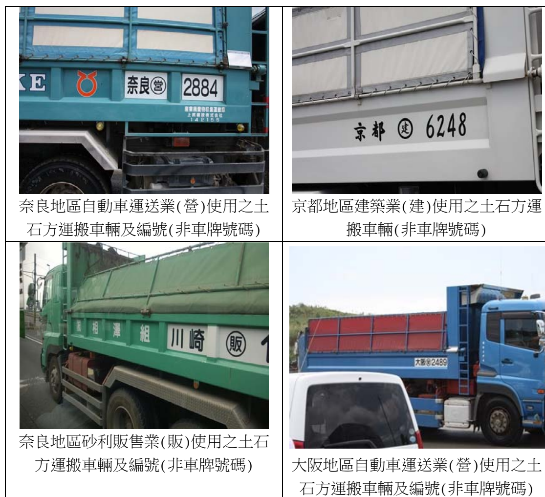
圖 4-3-1：日本運搬土石車輛車廂標示
