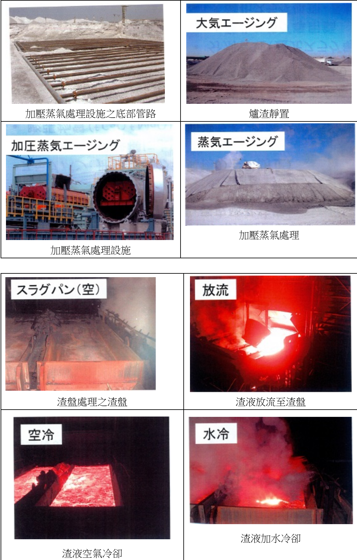
圖 3-2-2：傳統「土間處理」及「渣盤處理」圖(資料來源：授課講義內容)
