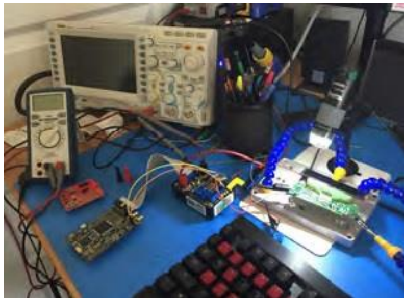
圖：藉由電流、電壓改變，修改韌體，攻擊硬體錢包
