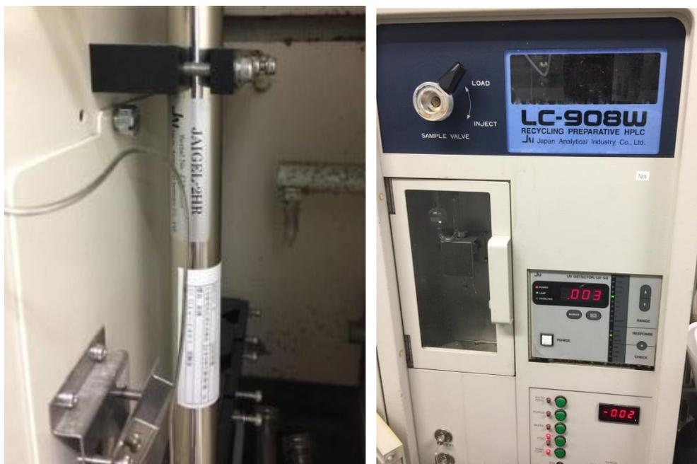
圖二十、櫻井實驗室循環製備級 HPLC 及管柱
