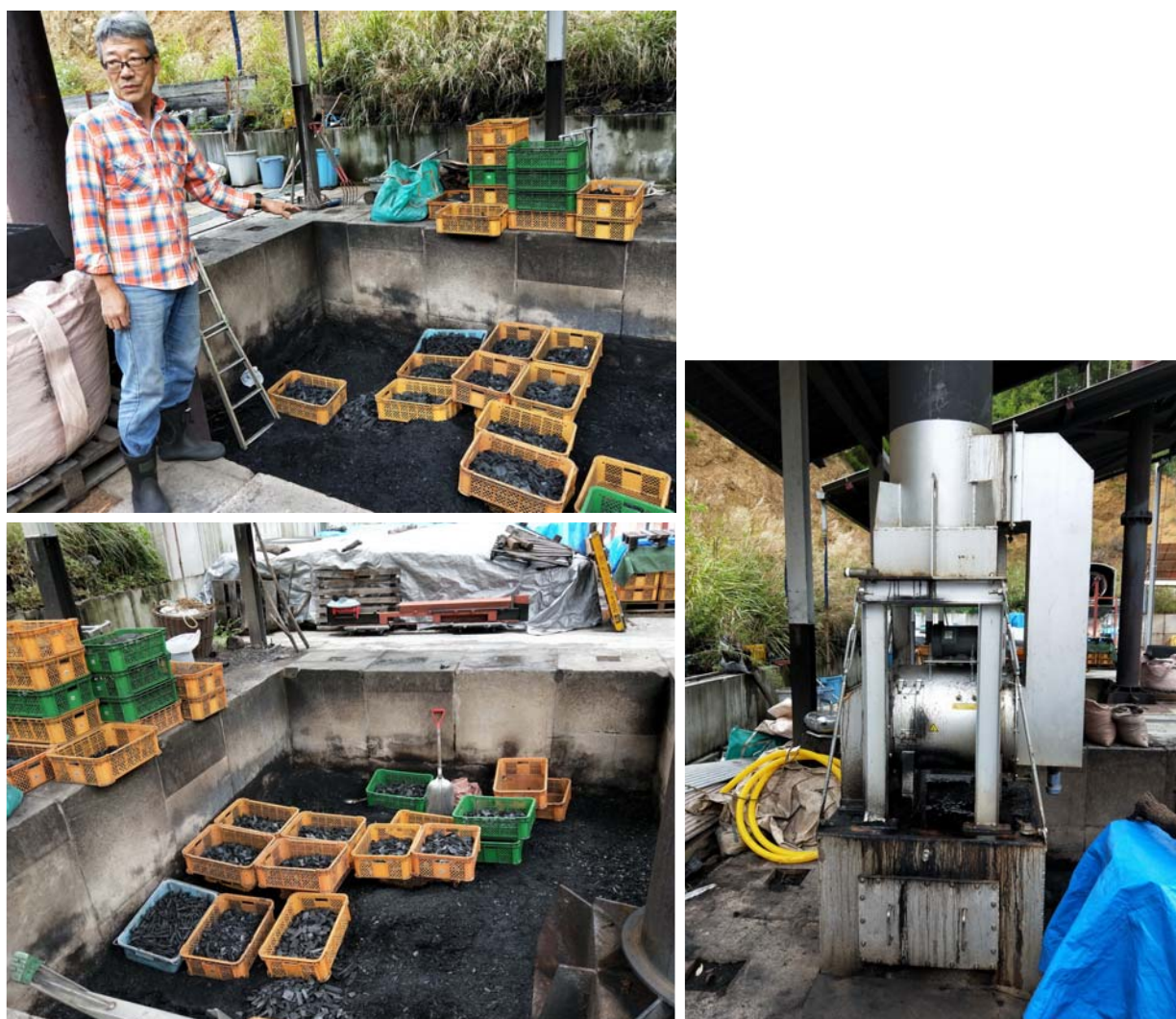
圖 7 島田先生介紹所經營燒製生物炭之工廠(左上、左下)及收集木醋液之設備(右下)。
