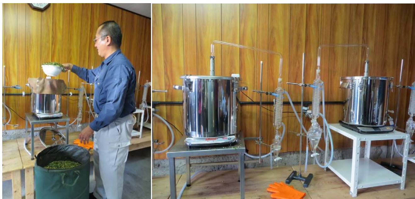
圖 15 佐野先生示範精油生產製程(圖左)及安裝妥之精油萃取設備(圖右)。
