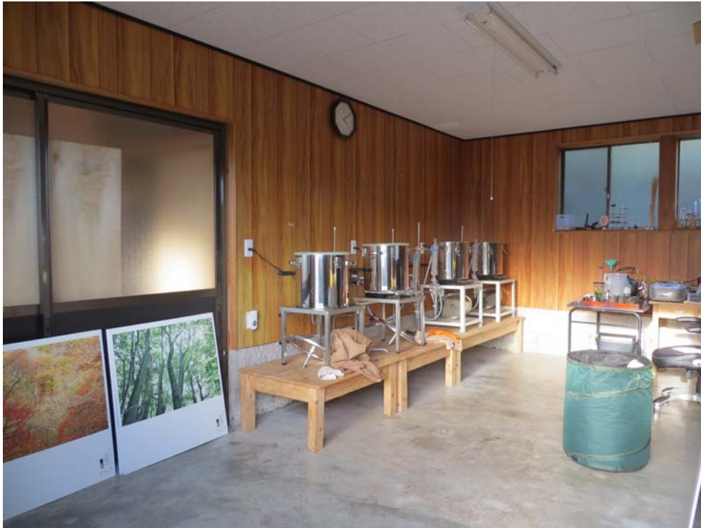
照片 15 能登精油製作場所投資設置之簡易萃取精油設備，以電磁爐為加熱源，可精準控制加熱溫度，在製程上較安全。
