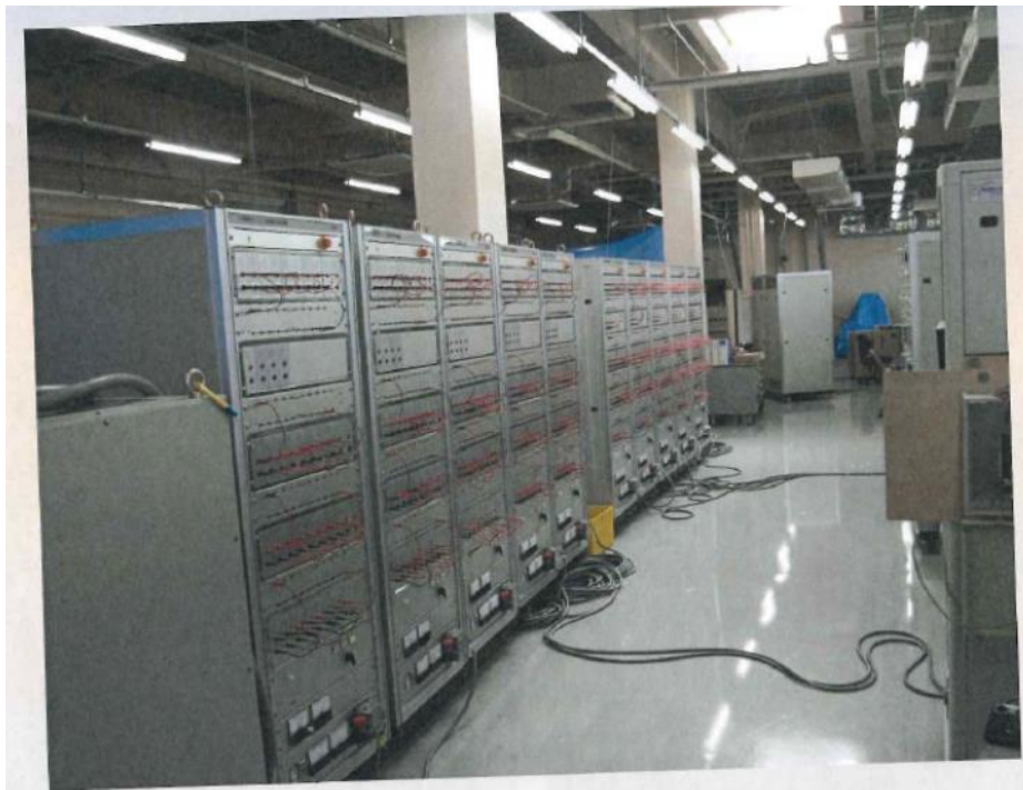
圖 17 機器開關試驗裝置
