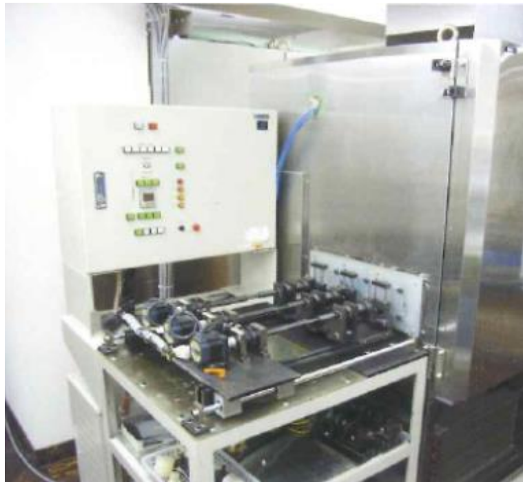
圖 16 機器開關試驗裝置
