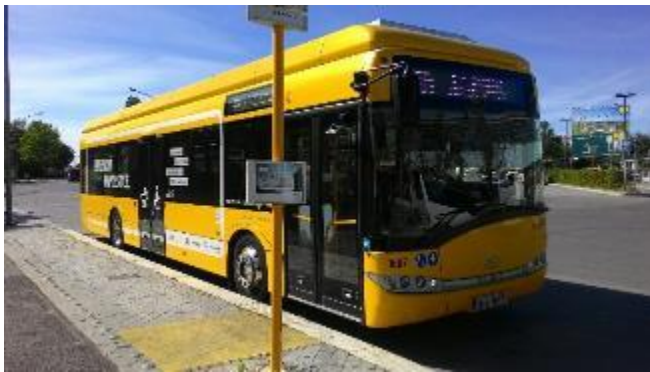
圖 48 利用地上電池充電的公共汽車--電動感應充電公共巴士系統(e-bus)
