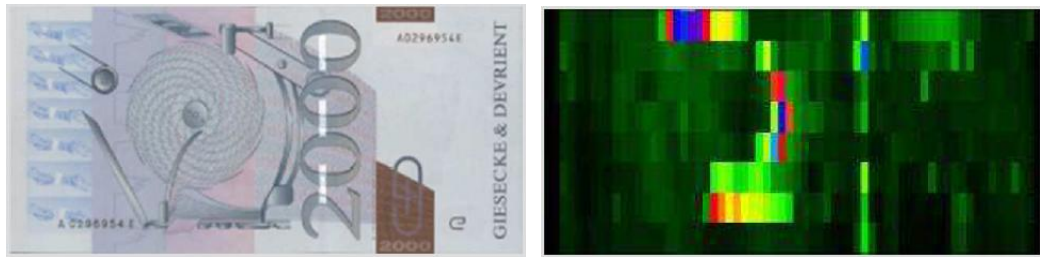
圖 34：原圖及 UV 傳感器影像
