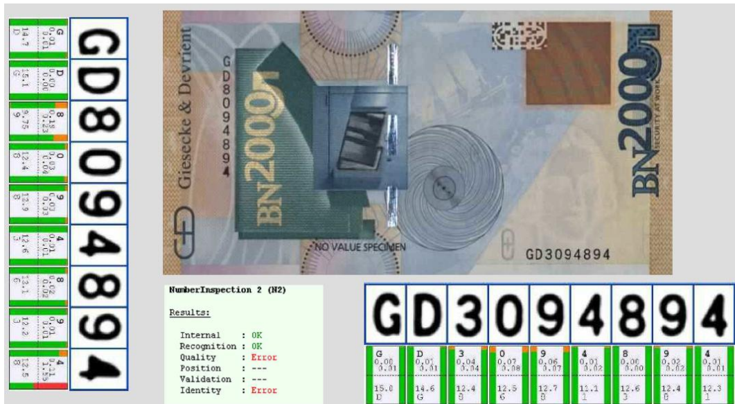
圖 28：號碼讀取及號碼品質檢查
