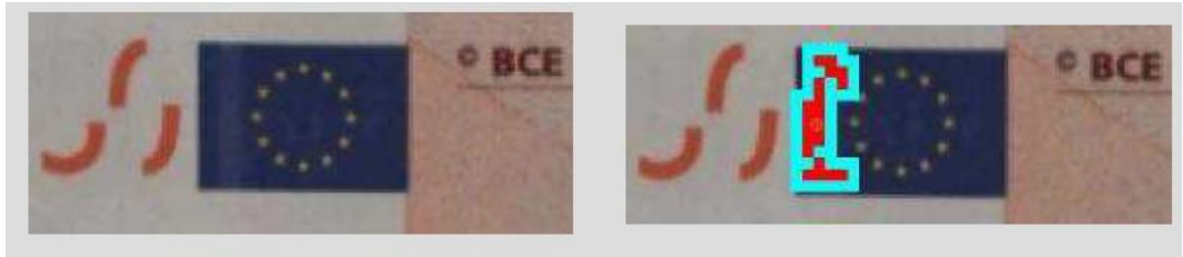
圖 19：印刷濃淡瑕疵
