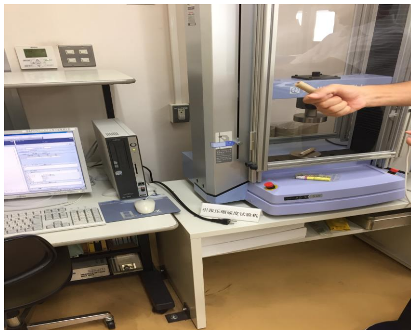
圖 3.10 測量紙管壓縮強度儀器
