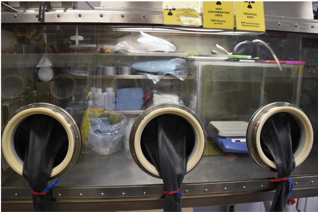
圖 27：CRL 形式手套連接端口
