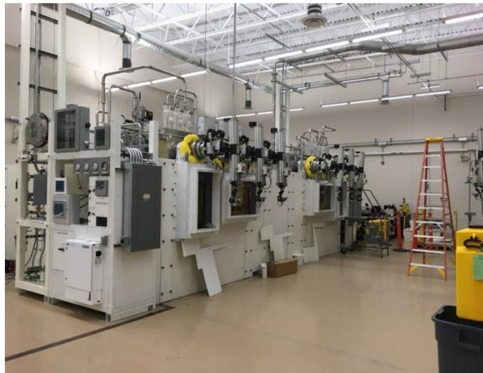
圖 38：屏蔽式 FEI Helios 雙束 SEM 與電漿 FIB
