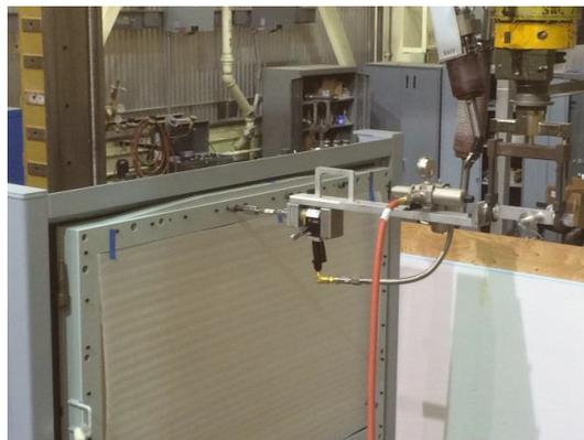
圖 34：機械手臂專用氣動扳手
