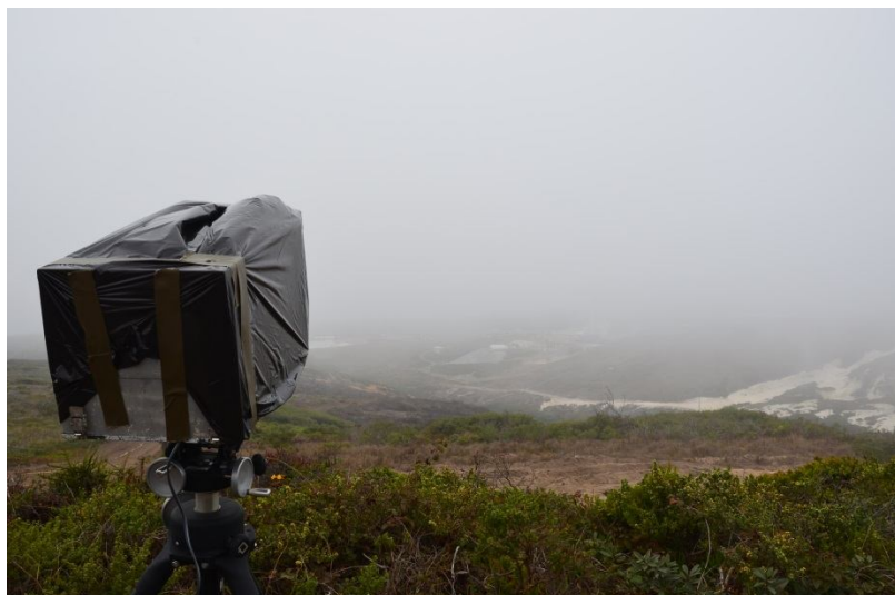
圖 12：現場架設攝影器材僅能以簡易塑膠袋進行防水措施
