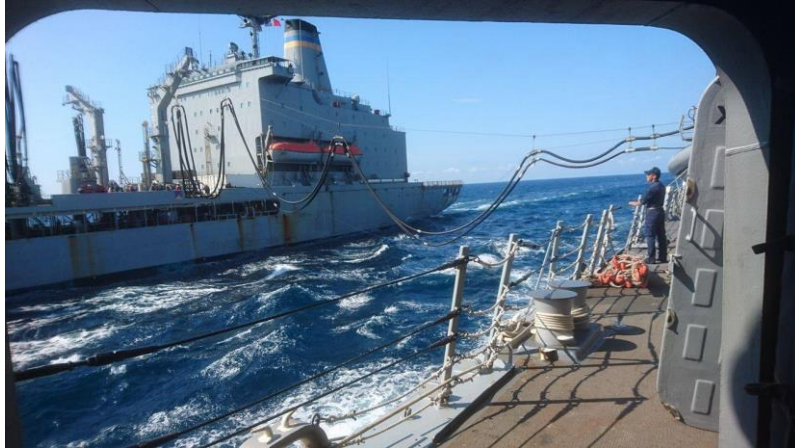
拍攝時間：中華民國 105 年 8 月 18 日 拍攝地點：勃克級驅逐艦(DDG-109)右舷 說明：執行海上加油
