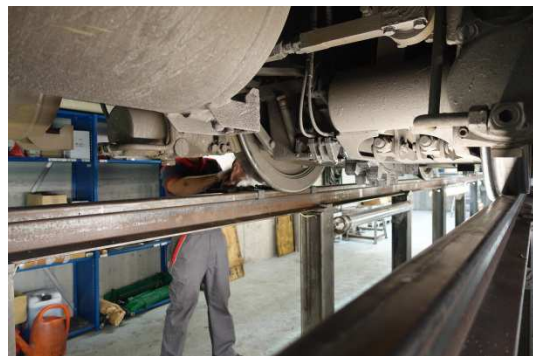
符合人體工學之檢修機坑與高架
