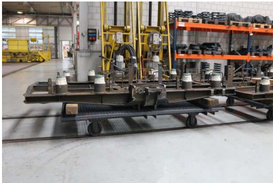
三、四級保養分解後之轉向架，放置於軌道推車上方便移動
