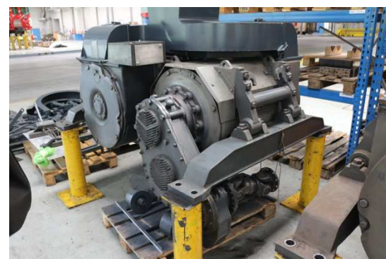
電動馬達及其傳動系統整修區，設計支架方便維修
