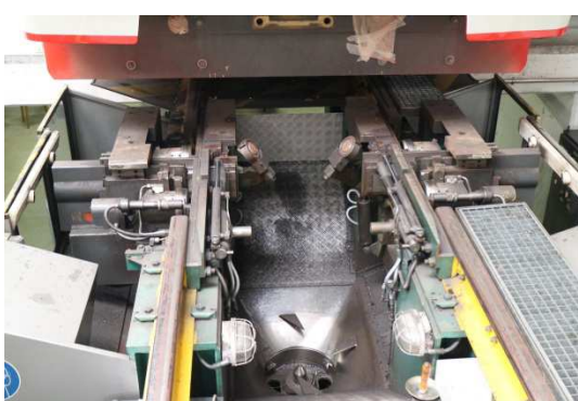
一般車廂車輪旋削專用機，車輪不需拆下即可旋削
