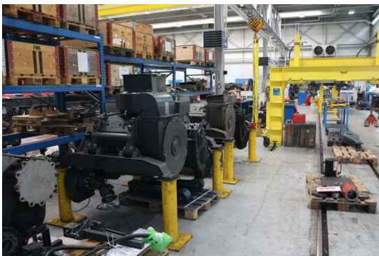
電動馬達及其傳動系統整修區，設計支架方便維修
