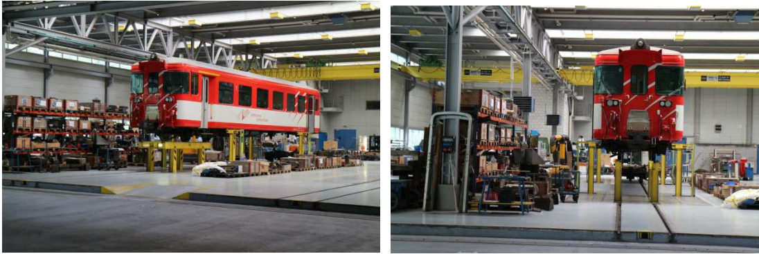
一般車廂較輕，採油壓頂昇機直接抬起
