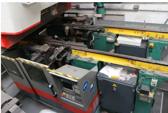
一般車廂車輪旋削專用機，車輪不需拆下即可旋削
