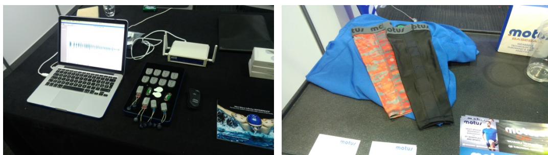
圖十五：可防水無線 EMG 偵測系統(左)及穿戴式運動訓練輔具(右)。
