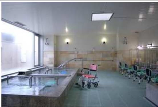
2 樓浴室：設置扶手及座椅，防止跌倒
