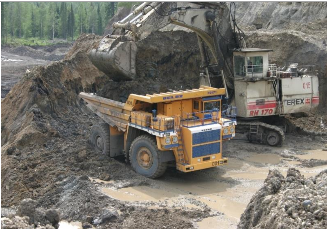
圖15：礦區開採設備-大型卡車(BELAZ 7517) (裝載量154-160公噸)
