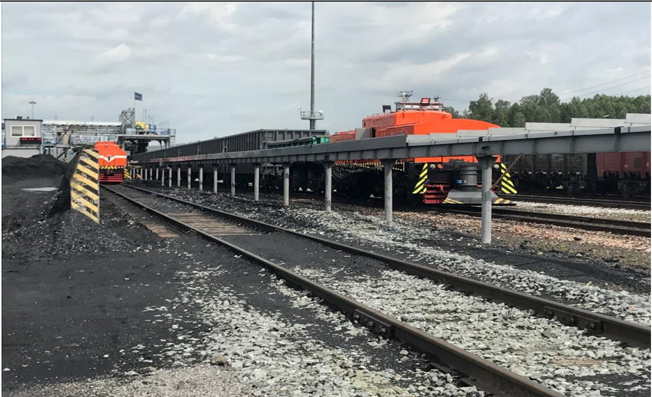
圖22：鐵路裝貨站調車用電氣機關車運作情形
