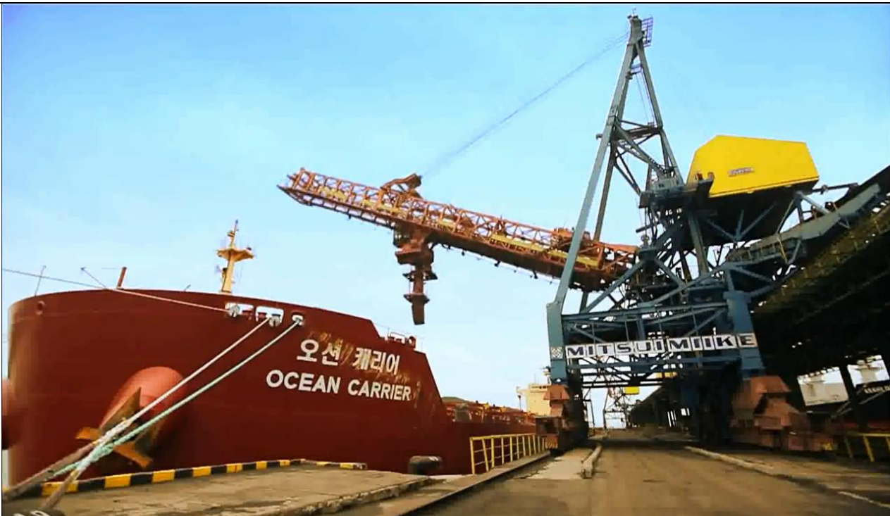
圖49：裝煤機外觀 (吊臂上下角度可達15度，以減少揚塵)
