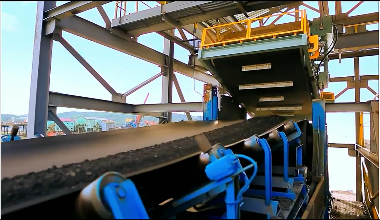
圖42：金屬偵測分離設備外觀 (共有42部金屬偵測設備，其中34部為金屬偵測分離設備)
