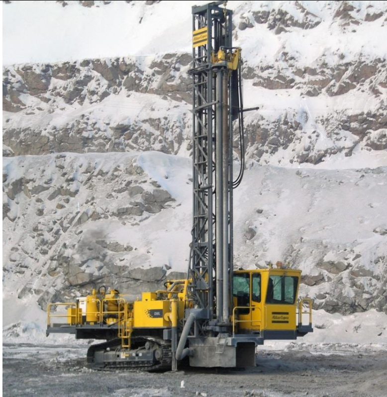
圖16：礦區開採設備-鑽孔機(ATLAS COPCO DML) (鑽孔深度可達53公尺)
