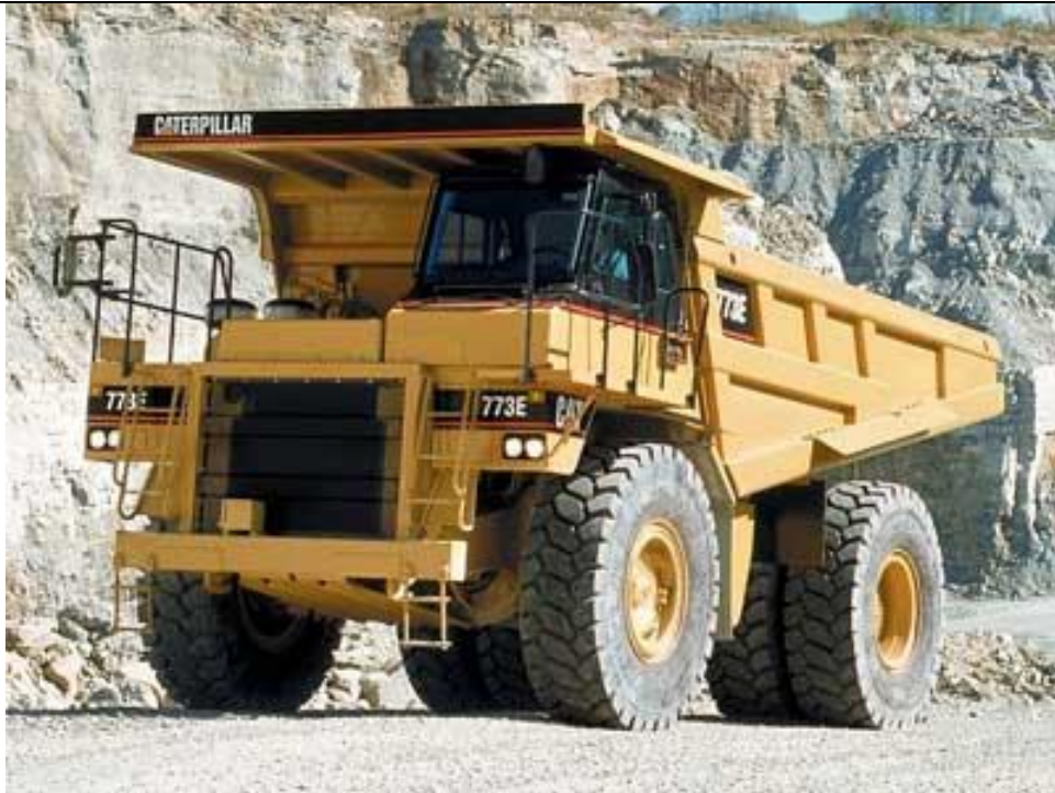
圖14：礦區開採設備-小型卡車(CATERPILLAR 773E) (裝載量44.8公噸)
