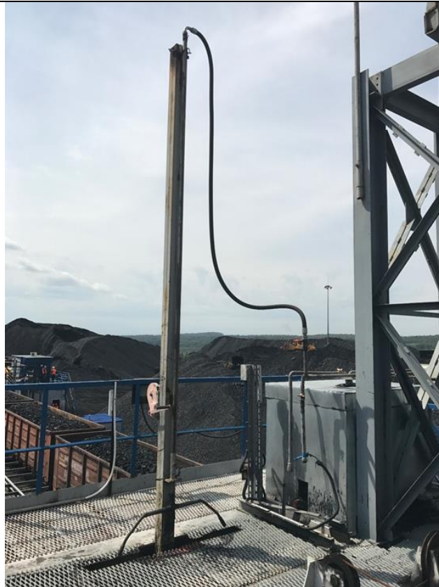
圖25：敞車防凍劑噴灑設備 (噴灑於車箱內部壁面及底板，非煤炭上)
