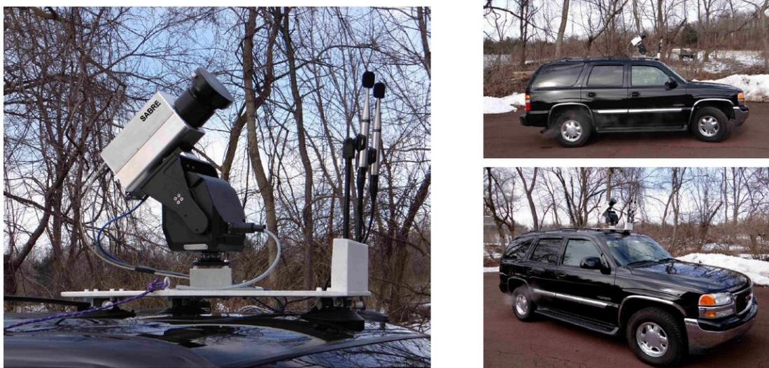
圖 17. SABER™系統安裝在多功能車輛上來檢查風機
