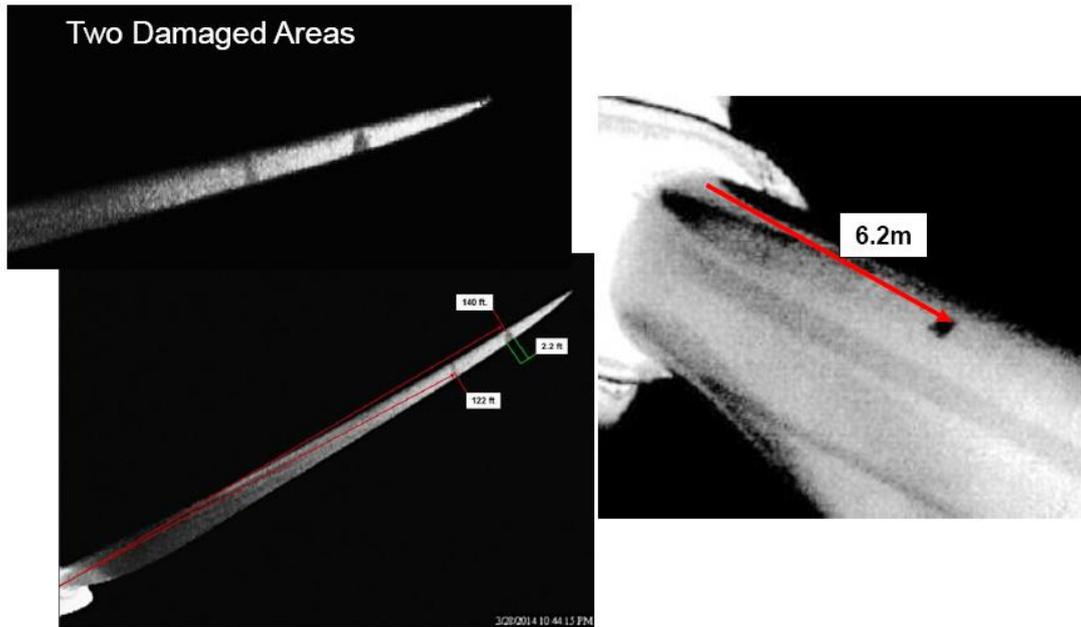
圖 14. SABER™系統中利用特定波長的遠紅外線（IR）檢測葉片的結構是否有有異常缺陷
