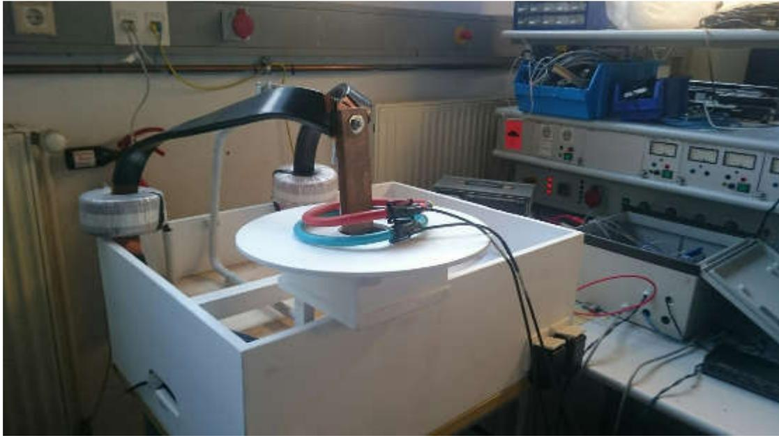
圖 15 模擬風力機大電流之裝置
