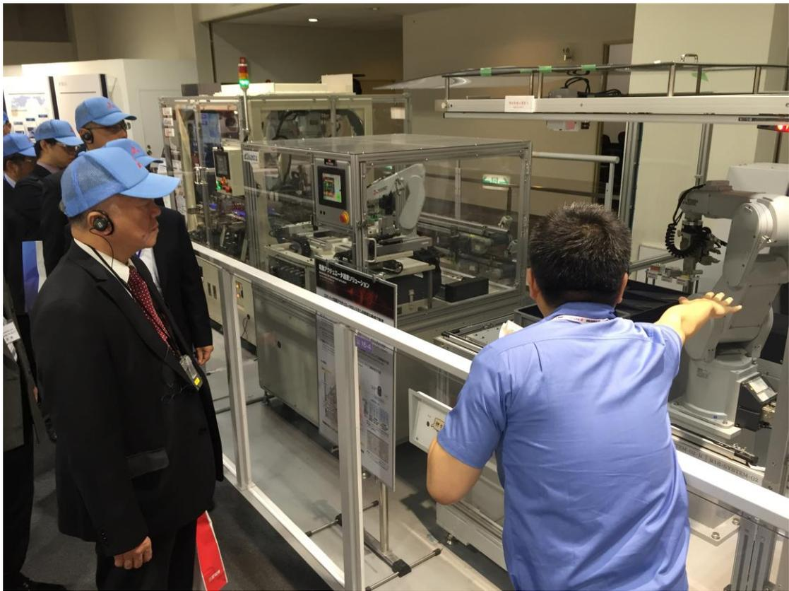
圖 10：生產線裝設自動柵欄感應異物以防止碰撞
