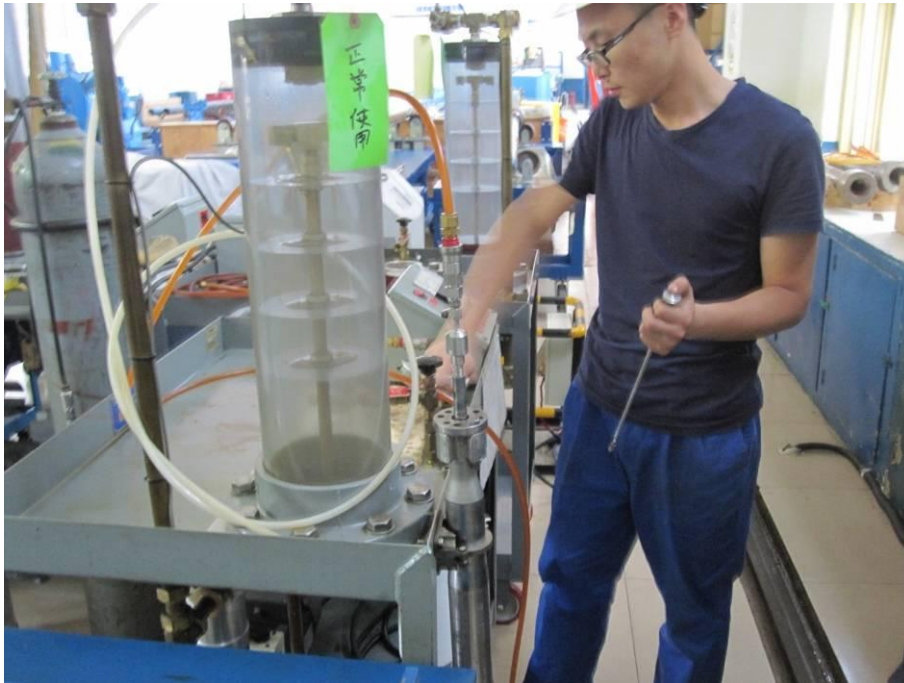
圖 20 泥漿脈衝發生器活塞抽真空注油畫面
