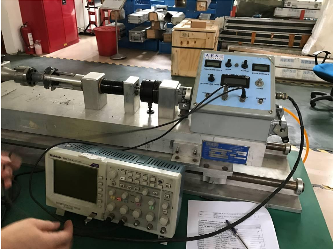
圖 21 泥漿脈衝發生器定轉子扭力負載測試
