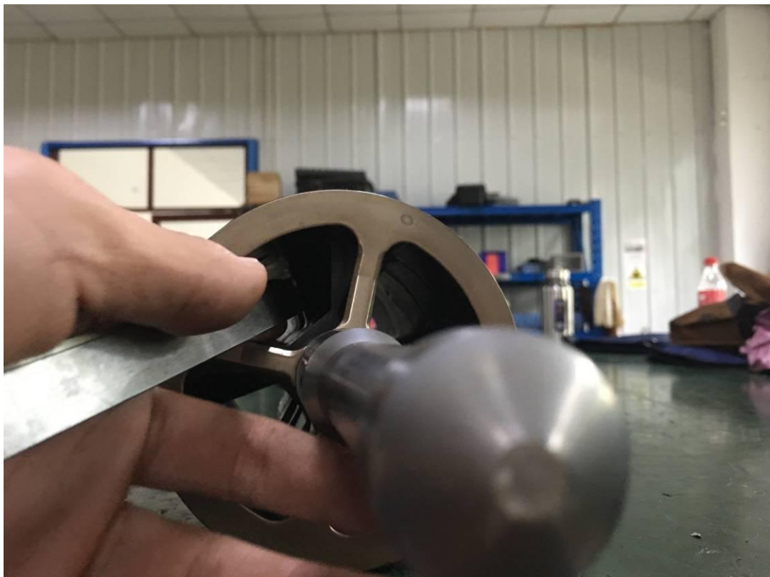
圖 3 泥漿脈衝發生器葉片開啟畫面
