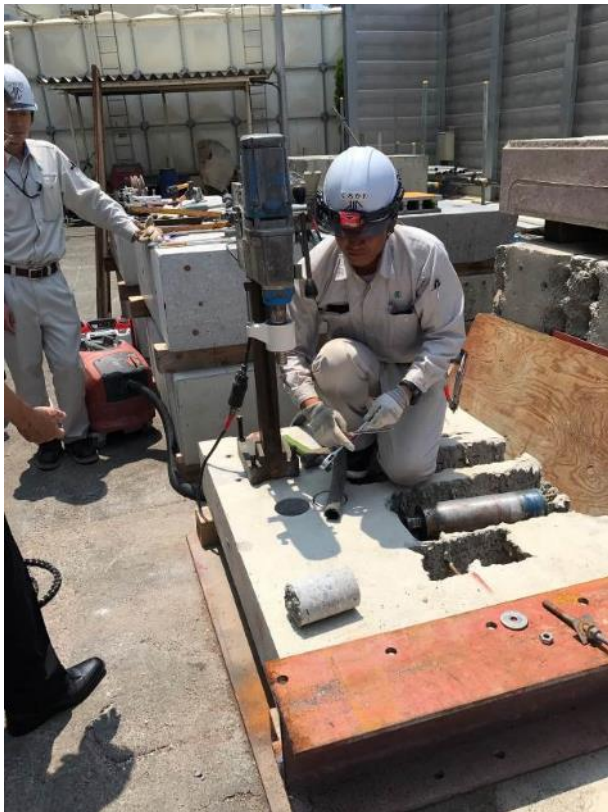
圖 66 鑽孔後取出之水泥圓柱示意圖
