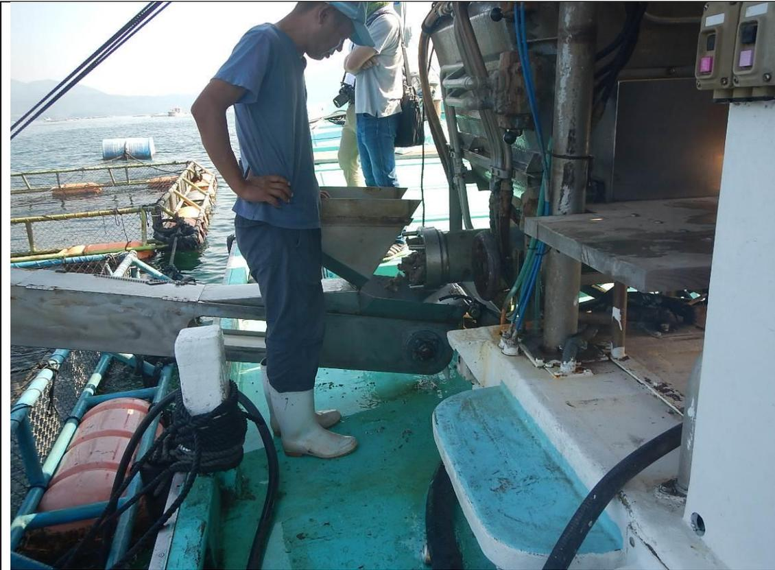
投餌造粒機的圓切盤，依業者的需者可更換孔徑尺寸及切刀速度
